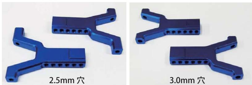
ダンパー取り付け位置をサスピンと同一線上に置き、
